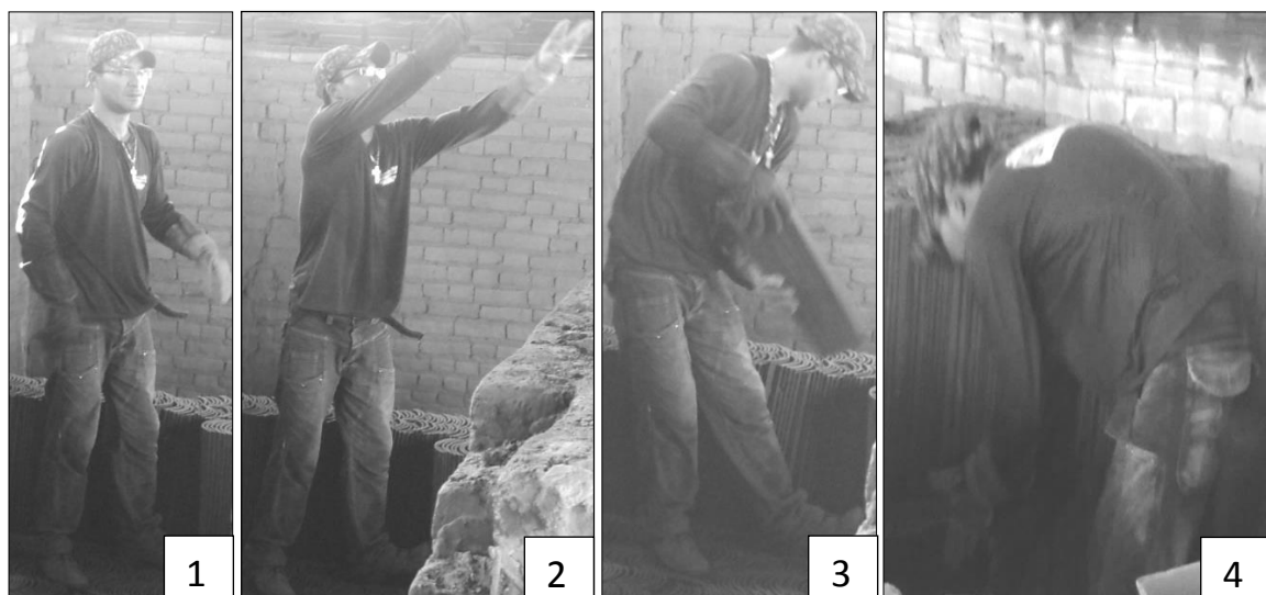
FIGURA 1 - Posturas típicas identificadas na atividade abastecimento de blocos cerâmicos em forno do tipo “caipira” antes da etapa de queima.
