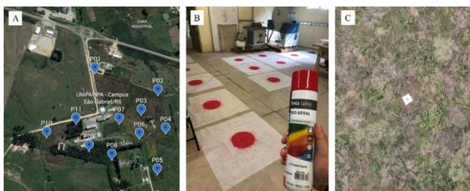
**Figura 1.** Distribuição dos pontos de apoio no campus da Unipampa e alvos artificiais usados nos vértices das parcelas e nos pontos de apoio (A), confecção dos alvos (B) Imagem obtida pelo VANT a 120 m de altura com detalhe do alvo em São Gabriel, RS, Brasil (C)
